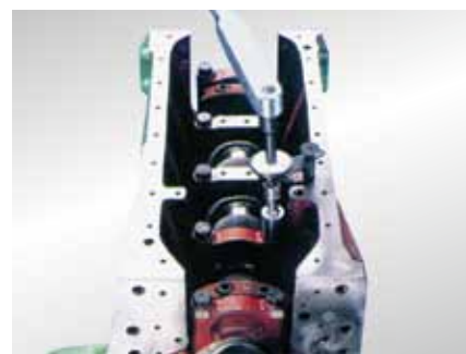
Проверка подшипника скольжения с помощью «KS Plastic Gauge»
