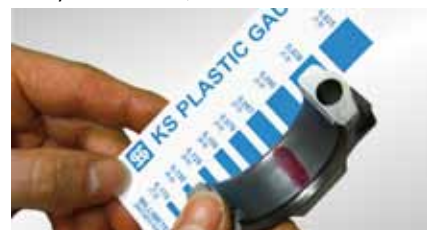
Проверка подшипника скольжения с помощью «KS Plastic Gauge»
