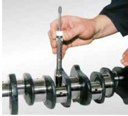
فحص التصلب باستخدام فاحص التصلب الارتدادي (رقم المنتج 50 009 812)
