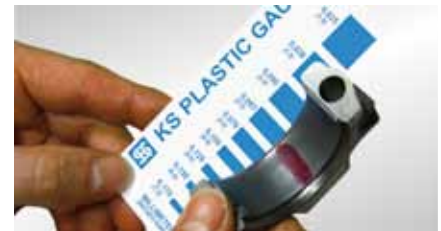
Contrôle du coussinet avec la « Jauge KS en plastique »
