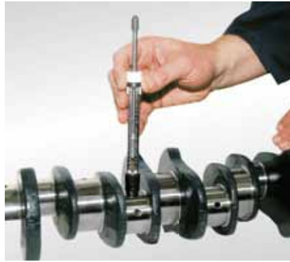
Контроль твердости склероскопом (товарный номер: 50 009 812)
