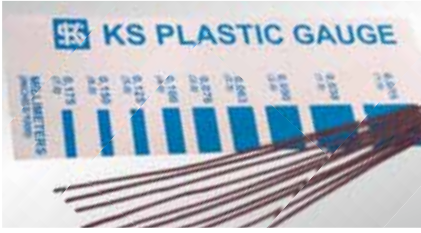
أشرطة القياس "KS Plastic Gauge" للمحامل الانزلاقية (رقم المنتج 50 009 880)
