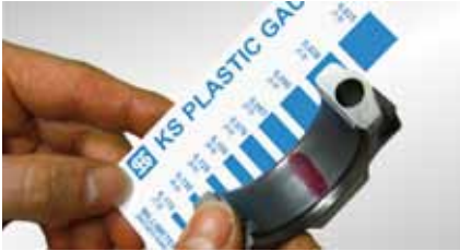
فحص المحامل الانزلاقية بأشرطة "KS Plastic Gauge"
