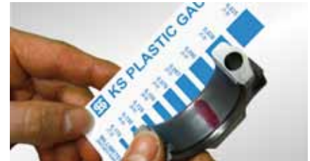
Control del cojinete de deslizamiento con la tira "KS Plastic Gauge"
