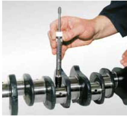
Härteprüfung mit Rückprall-Härteprüfer (Artikel-Nr. 50 009 812)
