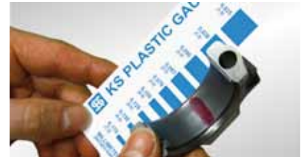
Prüfung des Gleitlagers mit „KS Plastic Gauge“
