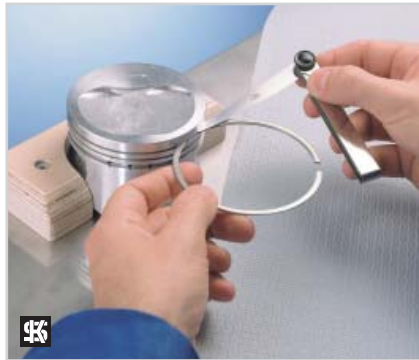
Messung der Kolbenringnuten mit einer Fühlerlehre. KS-Artikel-Nr. 50 009 824
