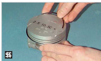
Segmento de engrase de laminillas de acero
