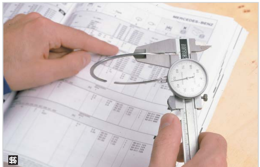
Prüfung mit KS-Messschieber mit Rundskala, Genauigkeit 0,01 mm. KS-Artikel-Nr. 50 009 814
