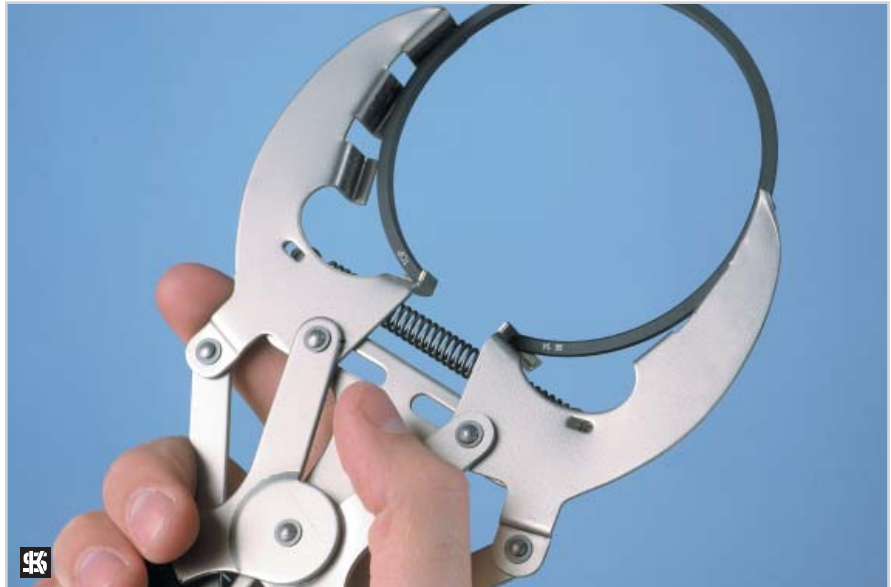
Tenazas de montaje de segmentos: N° de Art. KS 50 009 815 para Ø 50–110 mm N° de Art. KS 50 009 829 para Ø 110–160 mm
