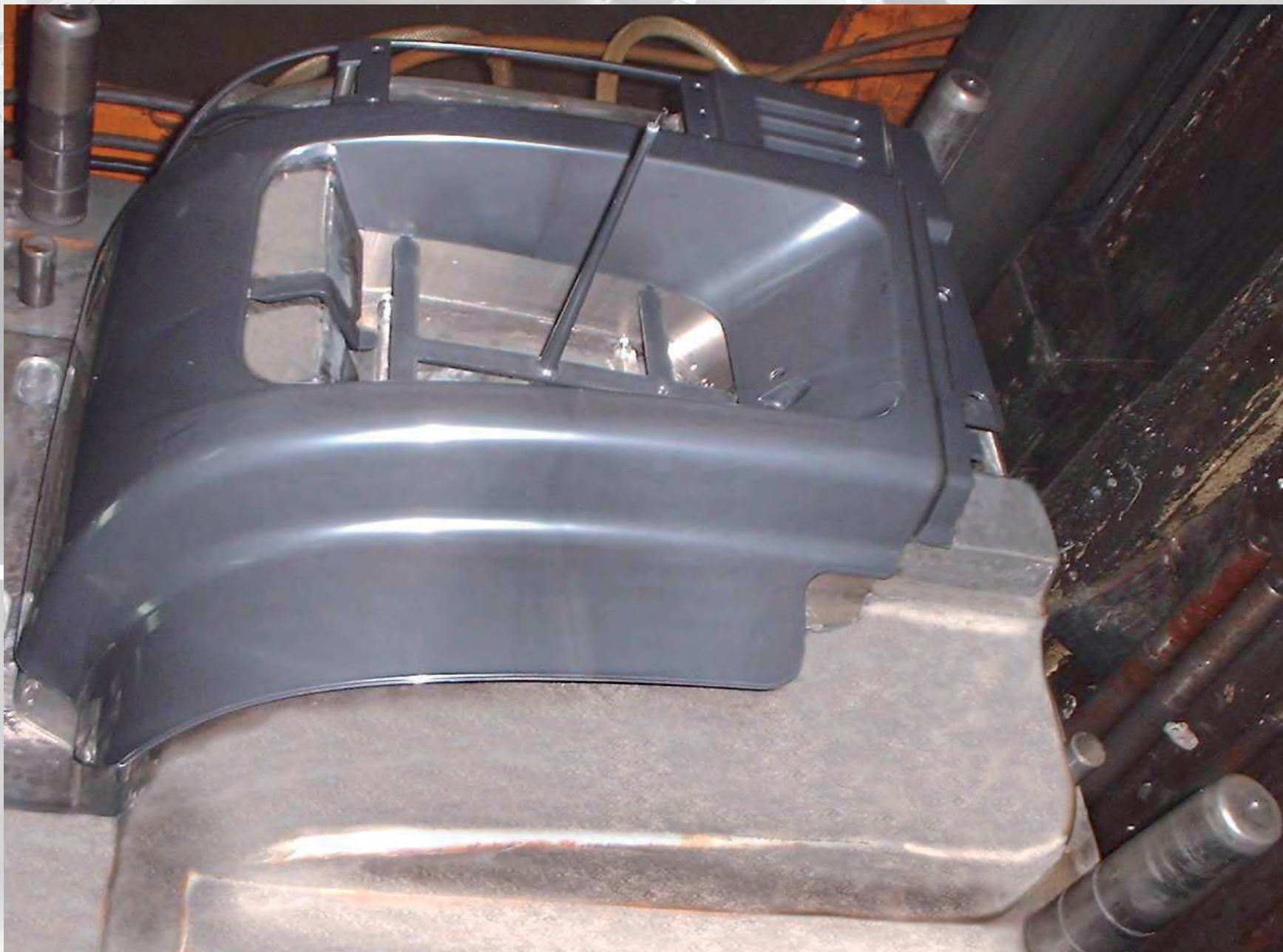
▲ Esemplare dell'angolare portafaro per il veicolo Volvo (Codice Covind 0FH/135) - Model of the headlamp rim for the Volvo vehicle (Cod. Covind 0FH/135)
