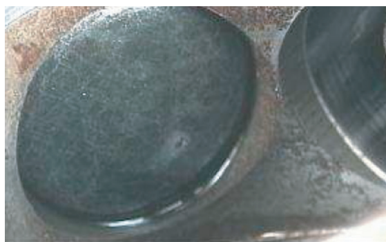
Корозія корпусу насоса високого тиску
