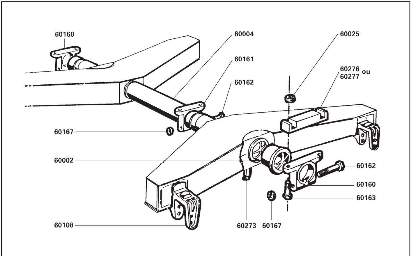
BALANCIER montage BENNE
